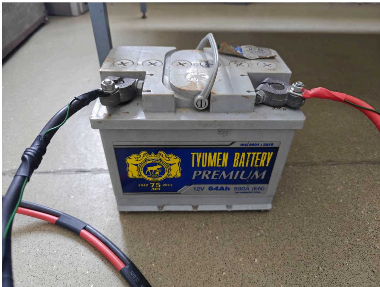
Рисунок 7 - Аккумуляторная батарея Tyumen Battery 12V 64Ah
