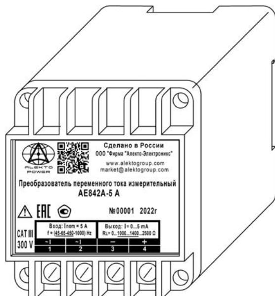
Рисунок 1.1 – Общий вид преобразователя модификации AE842A, AE842C
