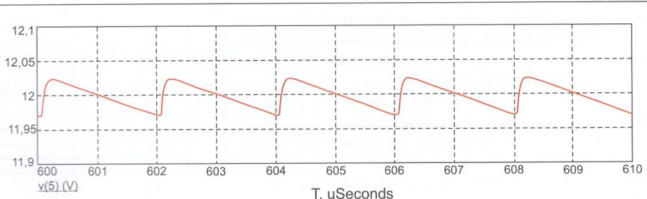
Рис. 7. Напряжение на выводах нагрузки
