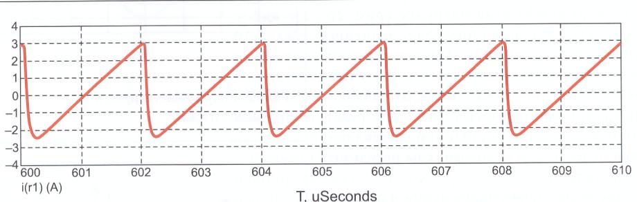
Рис. 6. Осциллограмма тока, протекающего в цепи источника GB1
