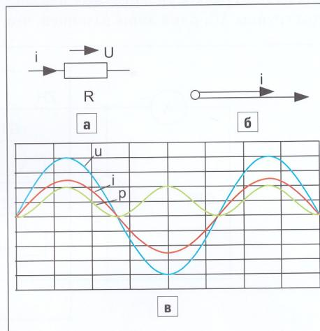
Рис. 1. Активная нагрузка в цепи переменного тока
