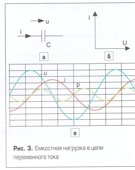
Рис. 3. Емкостная нагрузка в цепи переменного тока
