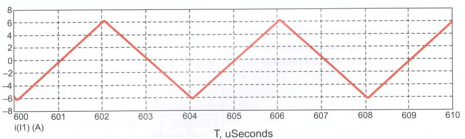
Рис. 5. Осциллограмма тока, протекающего через катушку L1
