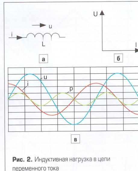
Рис. 2. Индуктивная нагрузка в цепи переменного тока
